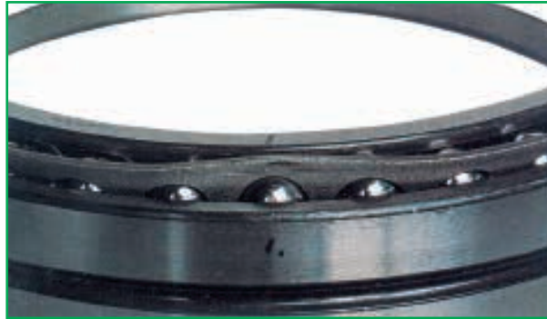
Fig. 1 Componente: gabbia di un cuscinetto a sfere a contatto angolare Evidenze: deformazione della gabbia stampata Causa: urti da movimentazione interna
