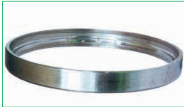
Fig. 2 Componente: anello esterno Evidenze: flaking della pista a passo sfera Causa: indentature causate da carico improvviso in condizioni stazionarie
