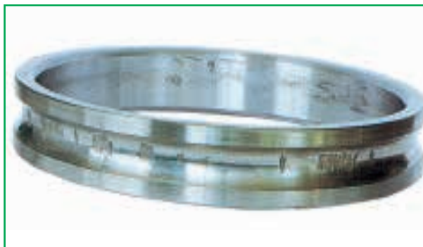
Fig. 2 Componente: anello esterno Evidenze: flaking della pista a passo sfera Causa: indentature causate da carico improvviso in condizioni stazionarie
